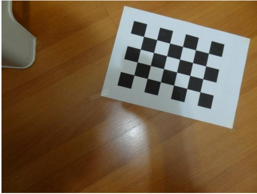
Figura 1 – Exemplo de padrão planar para calibração da câmera utilizado pelo algoritmo de Zhang.
