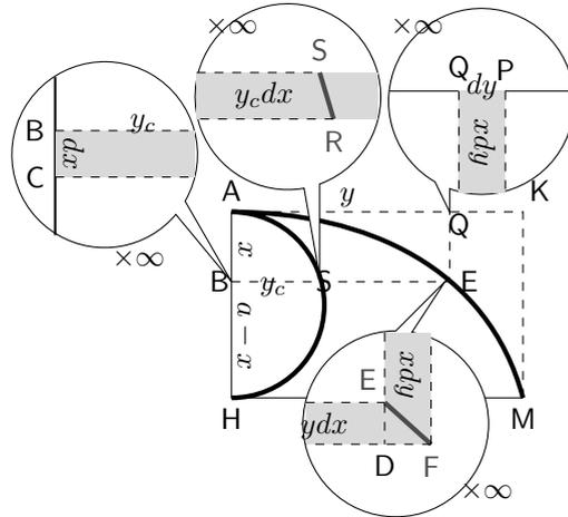
Figura 5.11: Gli incrementi infinitesimi delle variabili indicate nella figura precedente, utili per calcolare lo spazio della cicloide.
