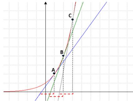
Figura 5.6: Sottotangenti relative ai punti  $A, B, C$  della curva  $y = 2^x$ .
