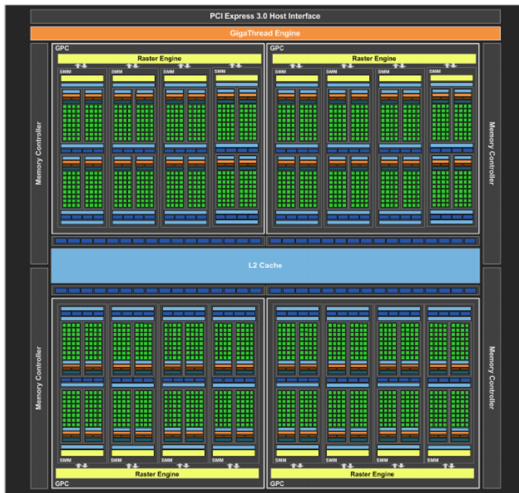
Figura 10: Microarquitectura de las placas Maxwell.
