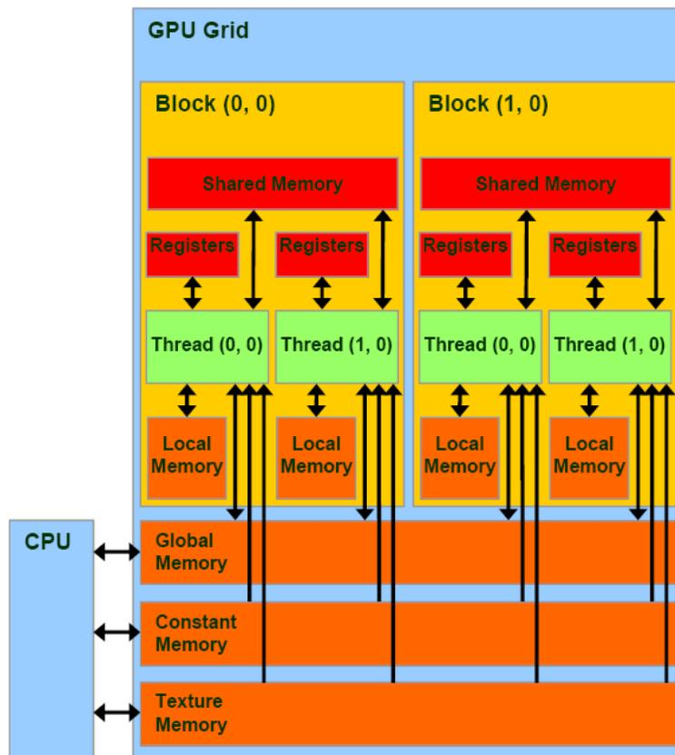
Figure 6: Estructura del GPU y la ubicación de sus memorias.
