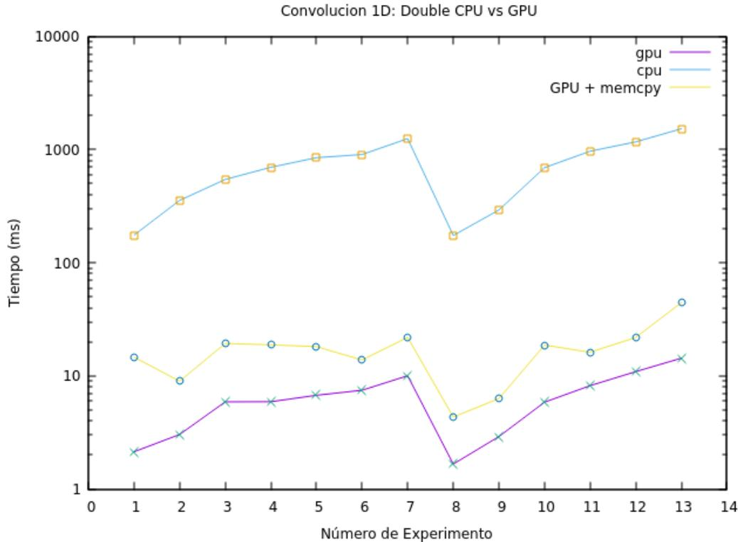
Figure 4: Resultados de ejecutar la convolución 1D usando tipos de datos double.
