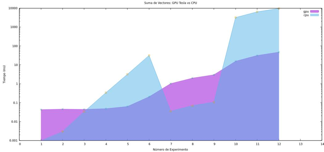
Figure 16: Resultados de la suma de vectores en las tarjetas gráficas Tesla.
