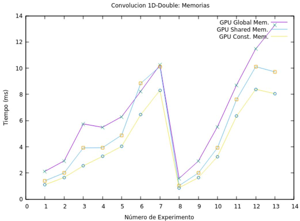
Figure 8: Resultados de la convolución usando distintos tipos de memorias y tipos de datos double.
