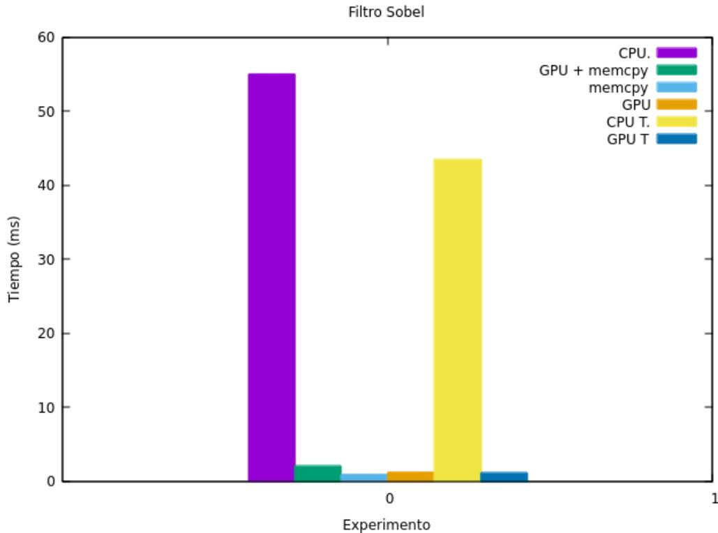
Figure 15: Tiempos de ejecución de la aplicación del filtro de Sobel en CPU y GPU.
