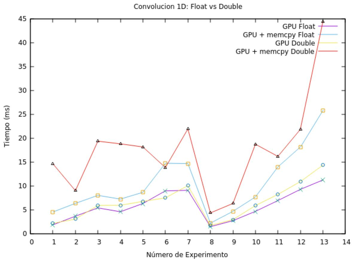
Figure 5: Comparativa entre la convolución realizada con Double y Floats.
