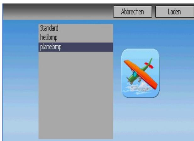
**Modelltyp [Model type]:** Wählen Sie den Modelltyp. Mögliche Optionen sind Heli und Flugzeug [Plane]. Helikoptermodelle haben eine weitere Konfigurations-Seite welche Sie erreichen können indem Sie den Modell-Typ anklicken. Diese Optionen sind genauer in Abschnitt 8.8.5 Taumelscheibe [Swash] Konfiguration beschrieben.
