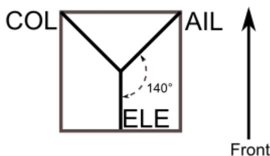
**90 (3 Servo):** Bei Querrudergabe neigen die Querruder- und Pitch-Servos die Taumelscheibe nach links und rechts, bei Höhenrudergabe schwenken die Servos die Taumelscheibe nach vorne und hinten, bei Pitchgabe heben alle drei Servos die Taumelscheibe hoch und runter. Überwiegend bei elektronischen Hubschraubern benutzt.
