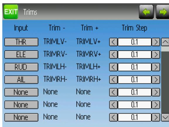
Die Trim-Stufe [Step] legt fest wie empfindlich die Trimmung auf Eingaben reagiert. Die maximale Zahl an Trimm-Stufen ist +/-100. Somit ergibt sich bei einem Stufenwert von 0,1 ein gesamter Trimm-Weg von +/-10% auf dem Servo.
