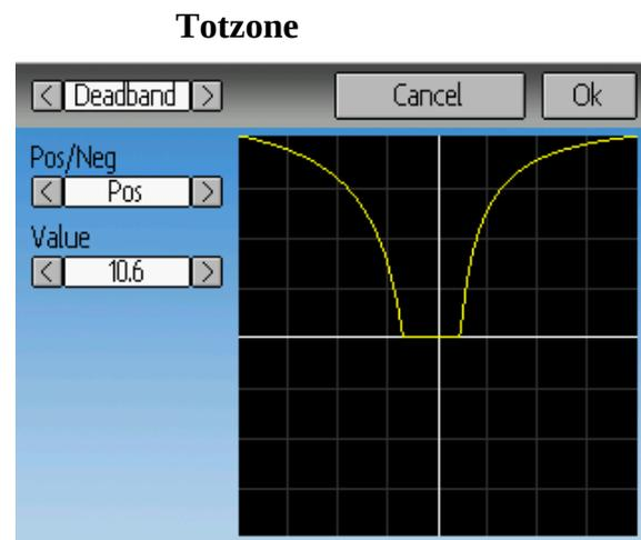
Bei der Totzonen [deadband]-Kurve kann man die Breite der Totzone für Werte größer Null und Werte kleiner Null getrennt einstellen.
