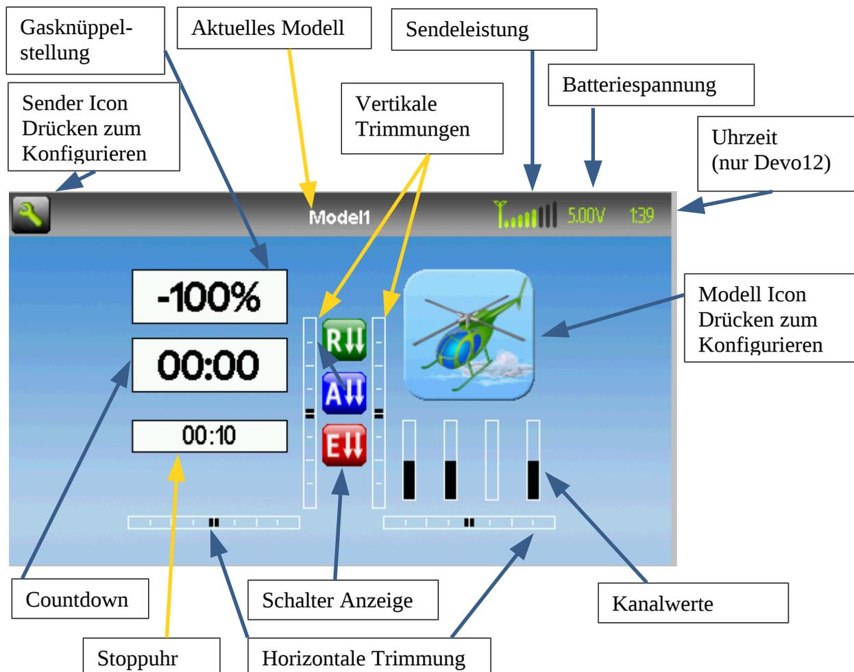
**Aktuelles Modell:** Name des aktuellen Modells. Drücken des Schildes öffnet die Modell laden Dialog [Model load]. Wird in Abschnitt 8.1 Modelleinstellungen [Model setup] (Standard & Advanced GUI) konfiguriert.
