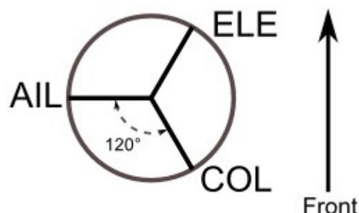
**140 (3 Servo):** Im Grunde sind die Servobewegungen bei 140° Taumelscheiben nahezu die gleichen wie bei 120° Taumelscheiben. Allerdings unterscheidet sich die Servo-Anordnung für die Höhenruderbewegung. 140° Taumelscheiben CCPM bietet eine glattere Bewegung der kombinierten Servos und umlaufend gleichmäßigen zyklischen Anteil. Bei einem 120° Aufbau ist zyklisch links/rechts, leicht schneller als vor/zurück zyklisch.
