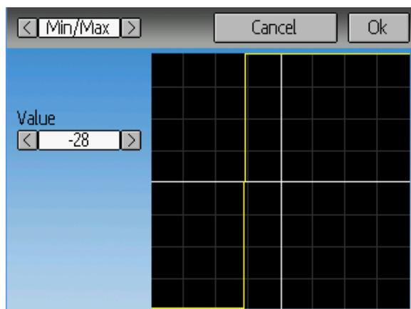
Bei der Expo-Kurve kann man die Form der Kurve getrennt für Werte größer Null und Werte kleiner Null einstellen.
