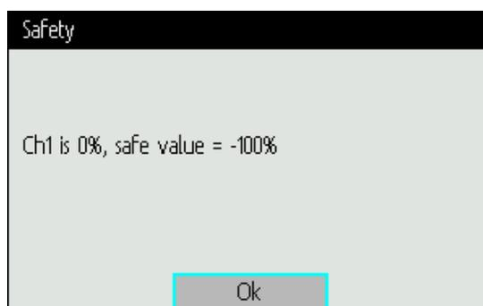
**Solange der Sicherheitshinweis angezeigt wird kommuniziert der Sender nicht mit dem Modell.** Dieser Hinweis kann entweder beim Einschalten, oder beim Wechsel zu einem anderen Modell erscheinen. Der Hinweis verschwindet, sobald alle Sicherheitsbedingungen erfüllt sind, oder durch Drücken der „ENT“ Taste. In jedem Fall beginnt die Kommunikation mit dem Modell, sobald der Dialog verschwindet.
