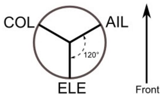
**120X (3 Servo):** So wie obige Anordnung mit der Ausnahme, dass die Servos 150° gedreht sind. Bei Querrudergabe neigen alle drei Servos die Taumelscheibe nach links und rechts, bei Höhenrudergabe schwenken das Höhenruder- und das Pitch-Servo die Taumelscheibe nach vorne und hinten, bei Pitchgabe heben alle drei Servos die Taumelscheibe hoch und runter.
