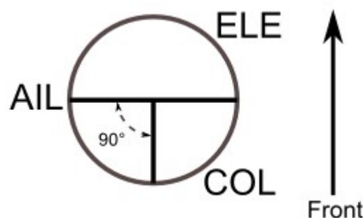
**Keine [None]:** Dies ist ein Spezialfall, wo die komplette Mischung im Hubschrauber gemacht wird unter Benutzung eines 3-Achs-Stabilisierungssystems. Bitte nehmen Sie Bezug zu den genauen Herstellerinstruktionen wie die Mischer-Ausgaben konfiguriert werden.
