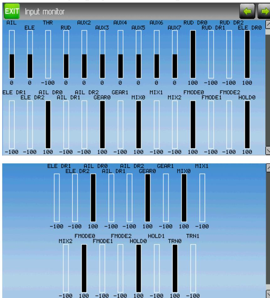
Die Eingaben Anzeige zeigt Werte, die mit der aktuellen Position der Stellwerte verbundenen sind. Die angezeigten Werte sind ein Prozentanteil des gesamten Bereichs der Bedienelemente basierend auf einer -100% zu +100% Skalierung.
