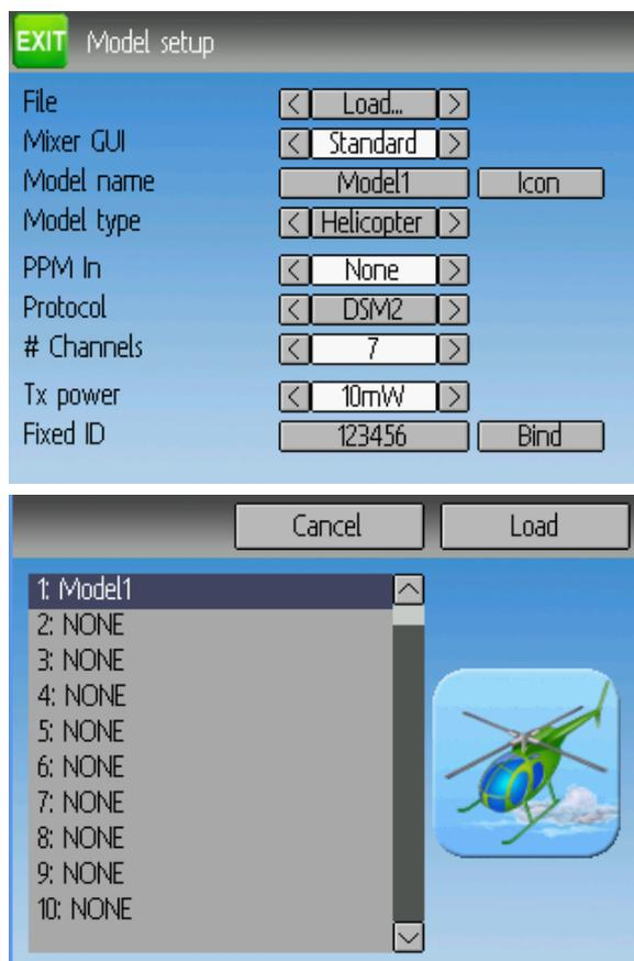
**Datei [File]:** Die Datei Spin-Box erlaubt das Laden [Load] neuer Modelle, Kopieren [Copy to] vorhandener Modelle an einen neuen Platz, Rücksetzen [Reset] des aktuellen Modells auf die Voreinstellung (alle Einstellungen gehen verloren), und das Laden von Vorlagen [Templates] (siehe 8.1.1 *Vorgefertigte Modellvorlagen [Templates]*). Beachten Sie, dass das Ändern des Modells zur Anzeige der Sicherheitswarnung führen kann (siehe 5.1 Sicherheitssystem).
