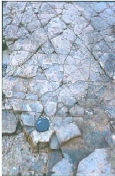
Figura 3.7: Alineamiento de fracturas distribuidas no perpendicularmente entre sí característica de un medio monoclínico.
