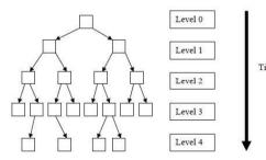
Zum Auffinden eines Elements werden maximal so viele Schritte benötigt wie der Baum tief ist.
