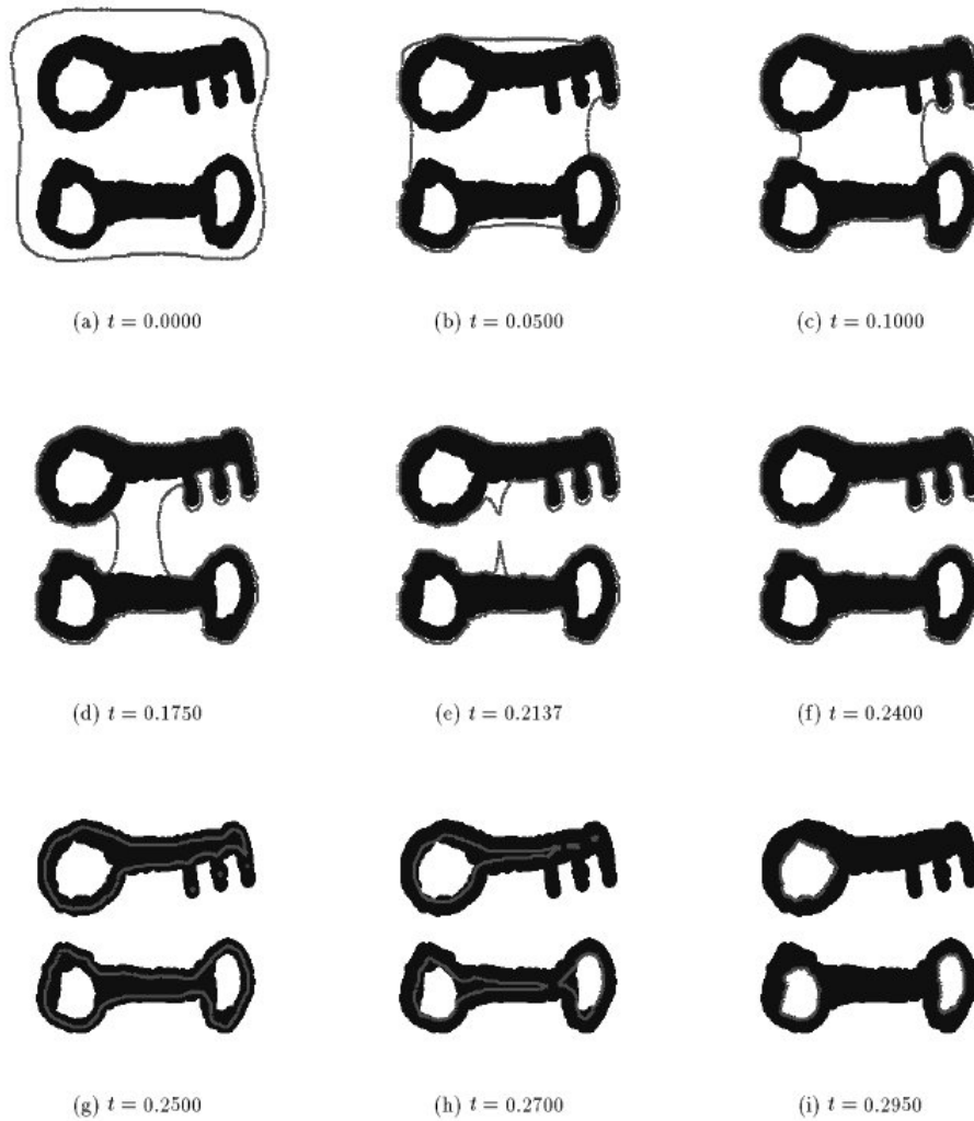
図 5: 閉曲線のトポロジーの変化 (文献 [1] から抜粋): 2つのオブジェクトを囲む大きな閉曲線 (a) は、(f) で2つのオブジェクトの外側の境界に沿った2つの閉曲線に分裂している (この図では判別できないが)。この2つの閉曲線はオブジェクト内部に入り込み、3つの白抜きの円を囲む3つの閉曲線に分裂する (i)。
