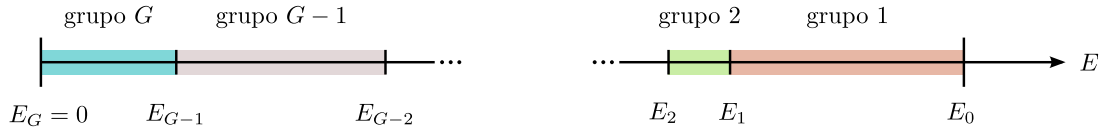
Figura 3.1: Discretización del dominio energético en grupos (volúmenes) de energía. Tomamos la mayor energía esperada E_0 y dividimos el intervalo [0, E_0] en G grupos, no necesariamente iguales. El esquema matemático es equivalente a una discretización por volúmenes finitos. El grupo uno es el de mayor energía.
