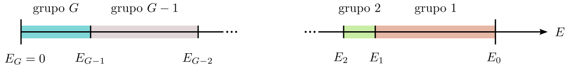
Figura 2.1: Discretización del dominio energético en grupos (volúmenes) de energía. Tomamos la mayor energía esperada E_0 y dividimos el intervalo [0, E_0] en G grupos, no necesariamente iguales. El esquema matemático es equivalente a una discretización por volúmenes finitos. El grupo uno es el de mayor energía.
