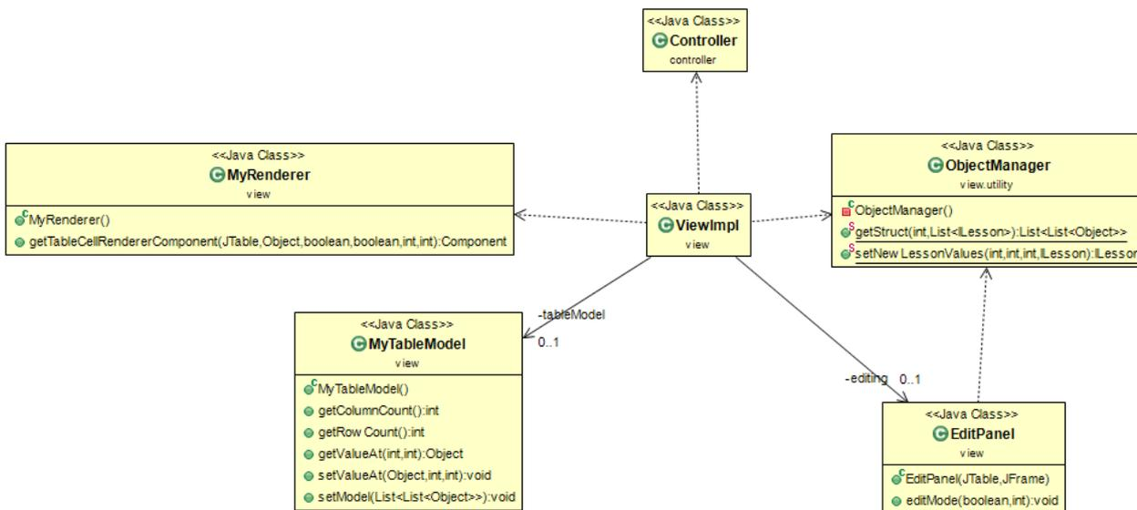
Per gestire le modifiche delle lezioni settimanalmente la view sfrutta completamente la classe EditPanel (che a sua volta usa la classe ObjectManager) che agisce sulla tabella tramite la classe ViewImpl e in seguito le modifiche vengono passate al controller che le passa al model.
