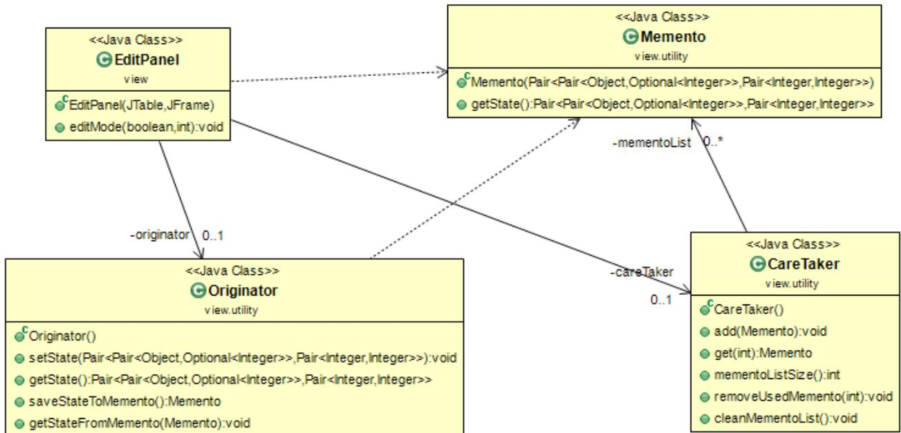
Pattern "memento" usato dalla classe EditPanel per usare le funzioni di undo e redo. Gli stati delle modifiche vengono salvati sotto forma di oggetti della classe Memento, tramite la classe Originator e in seguito gestiti dalla classe CareTaker.
