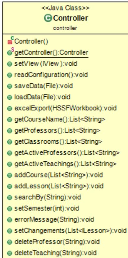
Il controller fa parte del pattern Singleton. In questo modo può essere richiamato da tutte le classi della view che ne necessitano senza il bisogno di dover passare ogni volta il riferimento di un oggetto Controller.
