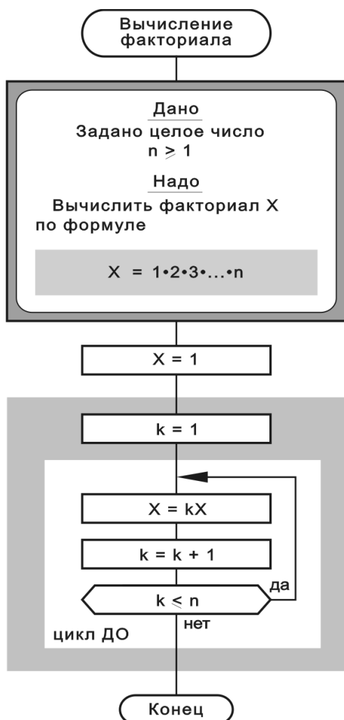
Рис. 84. Как вычислить факториал X = n! с помощью цикла ДО?
