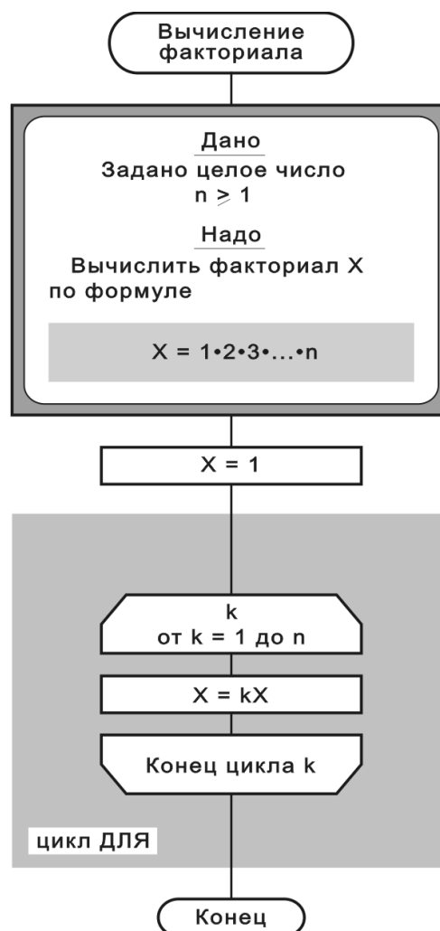
Рис. 85. Как вычислить факториал X = n! с помощью цикла ДЛЯ?
