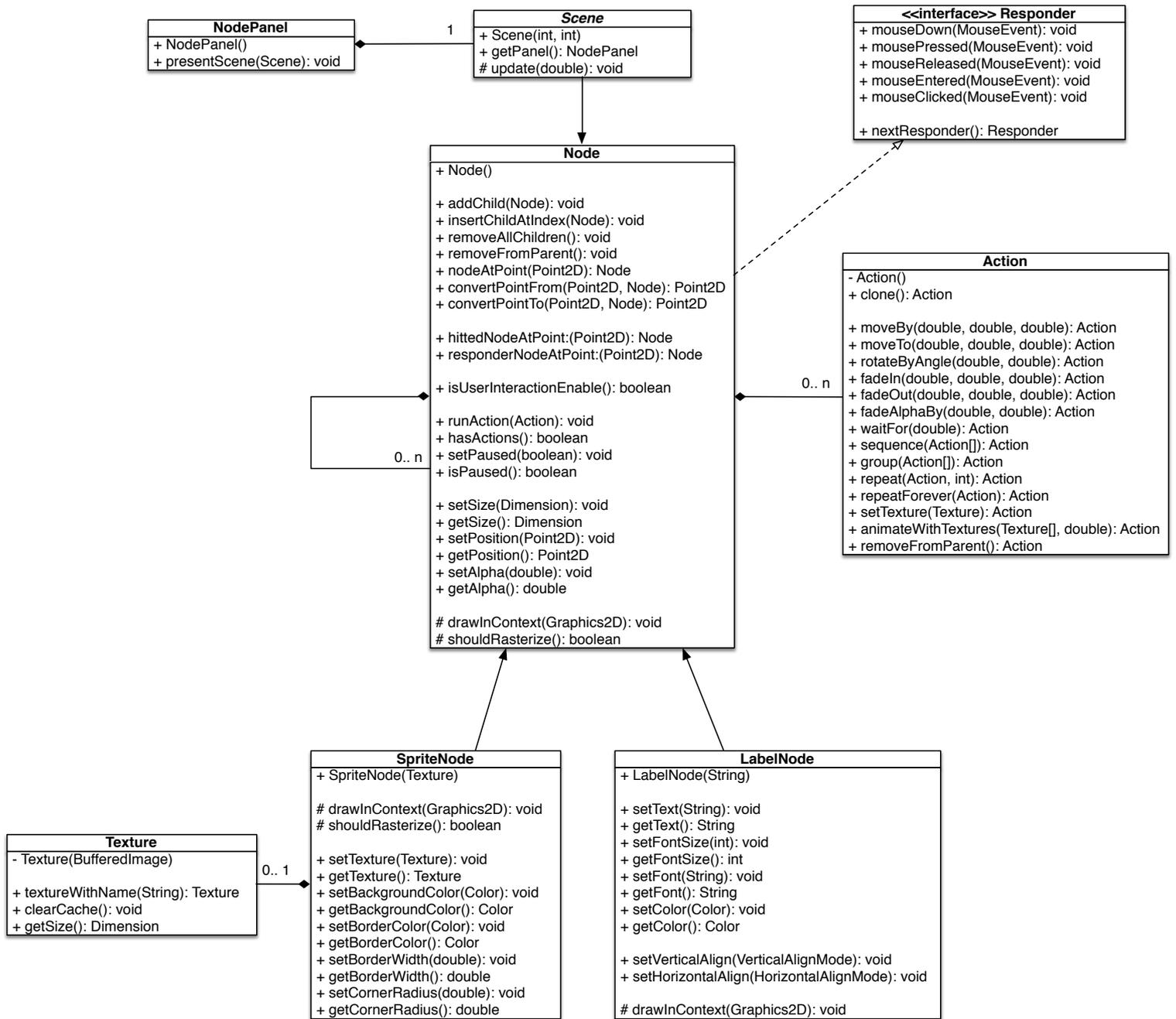
L'interfaccia del programma è composta da un controller principale, **MainController**, composto da una **MainWindow** contenente un **NodePanel**, utilizzato per presentare 4 scene principali:
