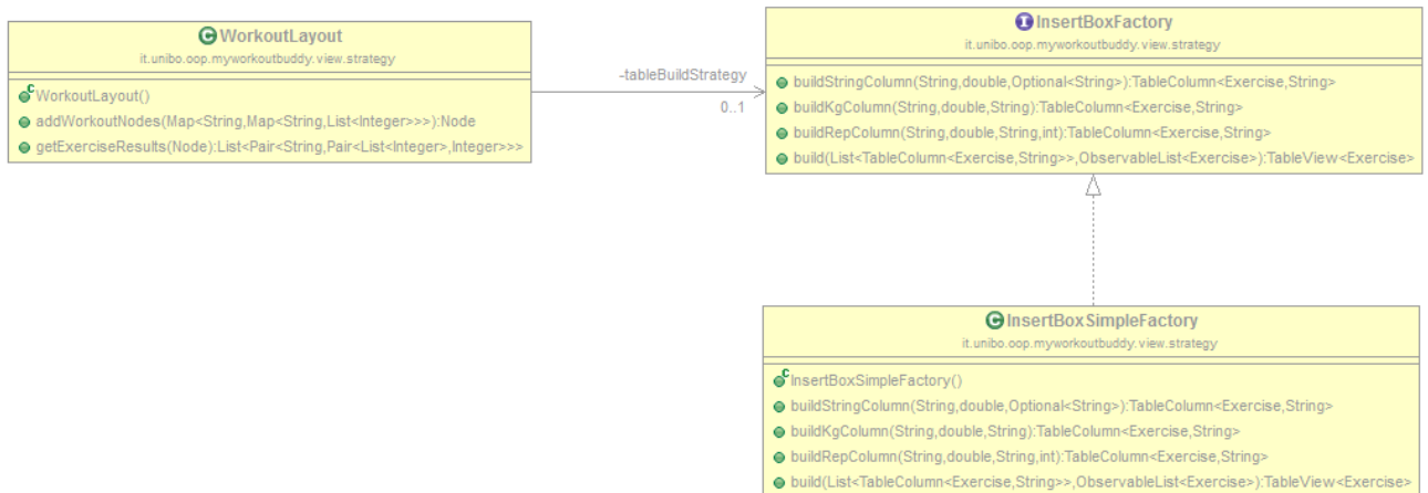
Schema UML del Simple Factory usato nell'implementazione della struttura utilizzata per contenere i dati dell'allenamento. La classe InsertBoxSimpleFactory incapsula i metodi per aggiungere nuovi campi definiti dai metodi in InsertBoxFactory .
