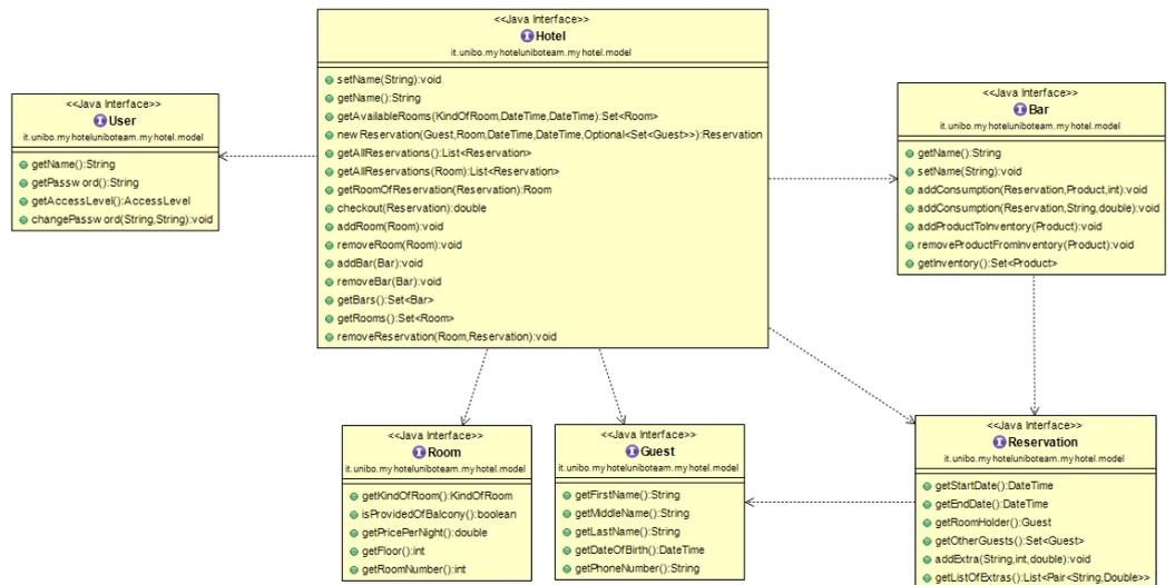
Figura 2.2: Architettura generale del Model, in cui è possibile vedere i principali metodi implementati dalle interfacce.
